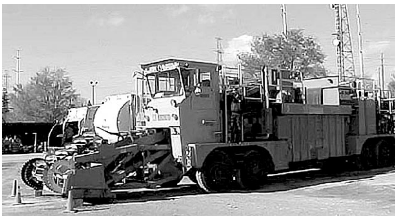
Рис. 13. Снеготаялка Metromelt производительностью до 150 т/ч на спецшасси со встроенным шнекороторным снегопогрузчиком канадской фирмы Тресан
