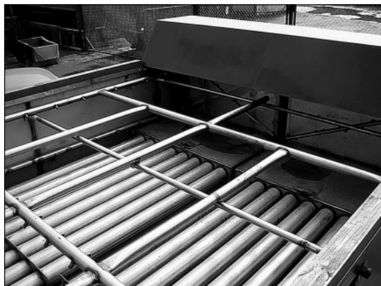
Рис. 16. Мобильная снегоплавильная установка СПУ-10 производительностью до 20 м 3 /ч на базе двухосного прицепа производства ООО «ВТК-Пром» с горелкой RielloRL (Италия)
