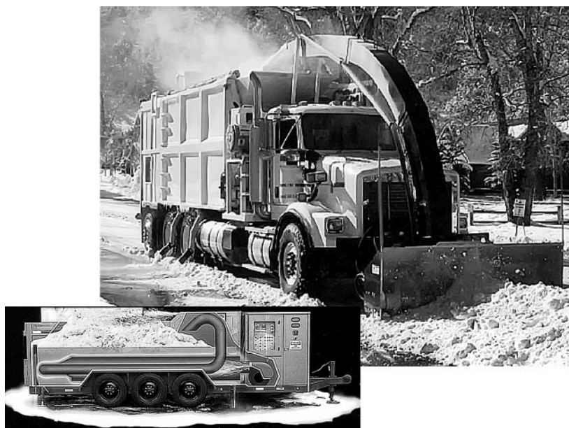
Рис. 15. Мобильная снеготаялка SRS-M150 в работе: слив талой воды при движении и загрузке убираемого снега
