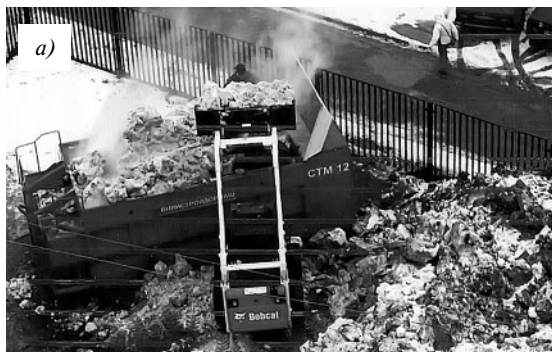
Рис. 17. Мобильная снеготаялка СТМ-12 в работе (а) и её снегоплавильная камера (б) конструкции ВНИИСтройдормаша
